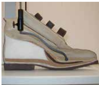
Der serienmäßige Vorfußtaster ermöglicht wahlweise das Messen im Ballenbereich
