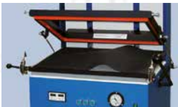
2 Müheloses Einlegen des Materials - Der Spannrahmen verbleibt im Gerät
