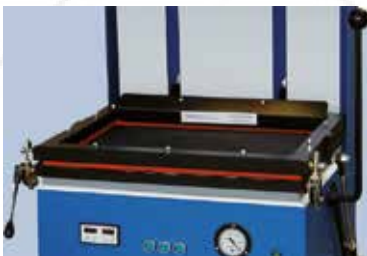
3 Leichtes Schließen des Spannrahmens durch Abwärtsbewegung, Verriegeln, Fertig.
