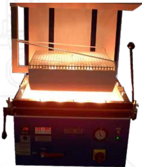
SONDERBAU: VACUPRESS 620S3 mit Spezialheizung und Thermostatregelung für den Photo- voltaik Bereich
