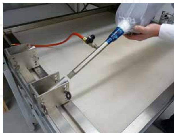
Werkzeuglose Platzierung der Modelle durch Absaugrohre mit Vierkantführung
