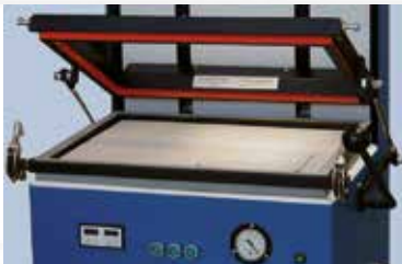
1 Einfaches Öffnen des Innenrahmens - auf etwa 45 Grad - mit der gewohnten Aufwärtsbewegung
