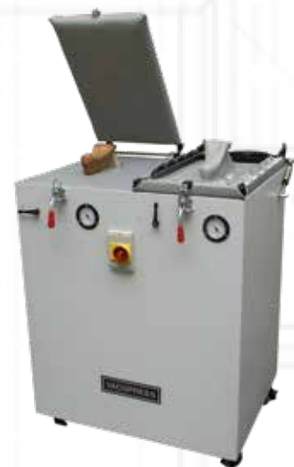
SONDERBAU: VACUPRESS 520 GK als Tan- demgerät mit Spezial-Vakuum- Schacht 250x250x500 mm. Va- kuum-Pumpe 10m 3 /h integriert. Das Gerät ist fahrbar.
